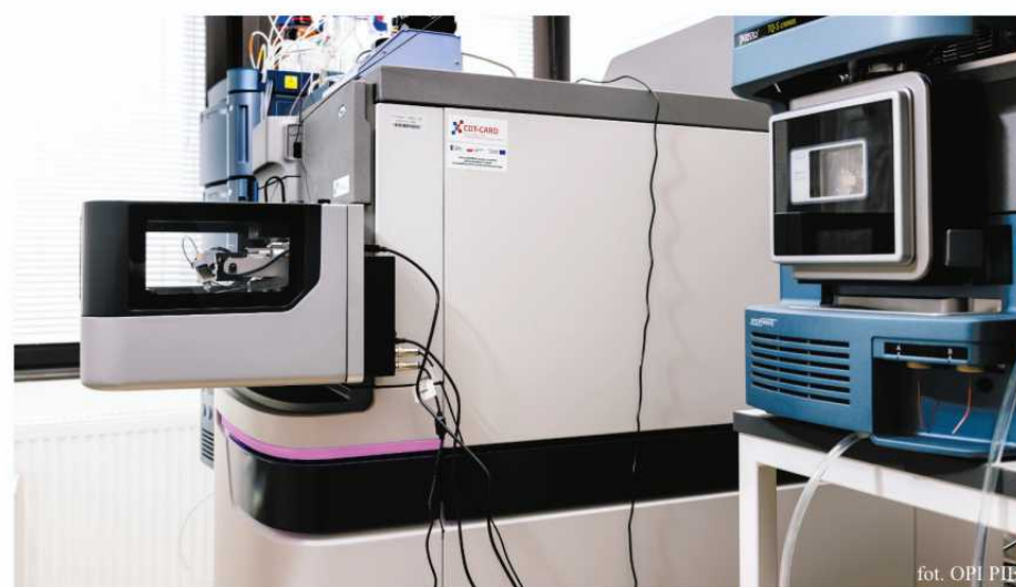
Laboratorium Małych Cząsteczek, zestaw UHPLC/HRMS
